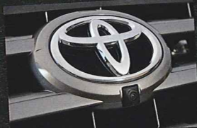
エンブレムやサイドミラーには小型カメラを埋め込んでドライビングをサポートする。
