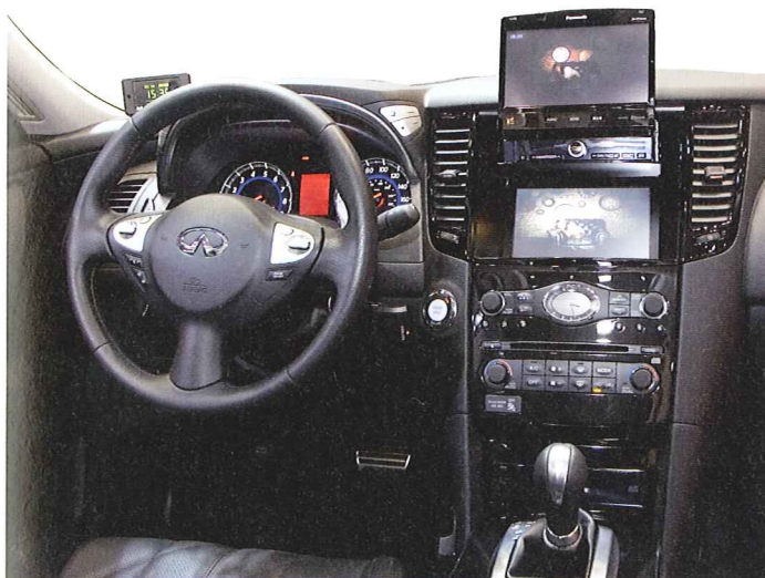
写真はインフィニティにナビゲーションをインストールした時の一例。純正のモニターを活かすためにインダッシュ式のナビゲーションシステムを選んだ。ナビゲーションの使い勝手を考え、エアコンユニットが装備されていた場所にインストールすることにした。エアコンダイヤルはルーフ内に移設し、開いた場所にナビゲーションをセットしている。
