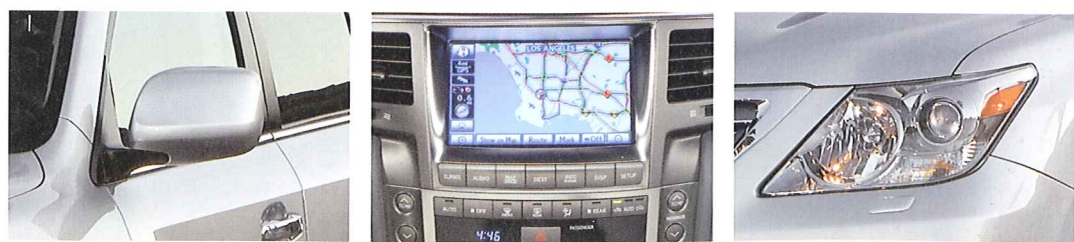
日本仕様に変更するには、保安基準に適合させるために、ドアミラーを折り畳めるタイプにすること、ヘッドライトの配光を左側通行に適した状態にすることなど、クリアしなければならない条件がいくつか存在する。また、オーディオ類にも注意が必要だ。
